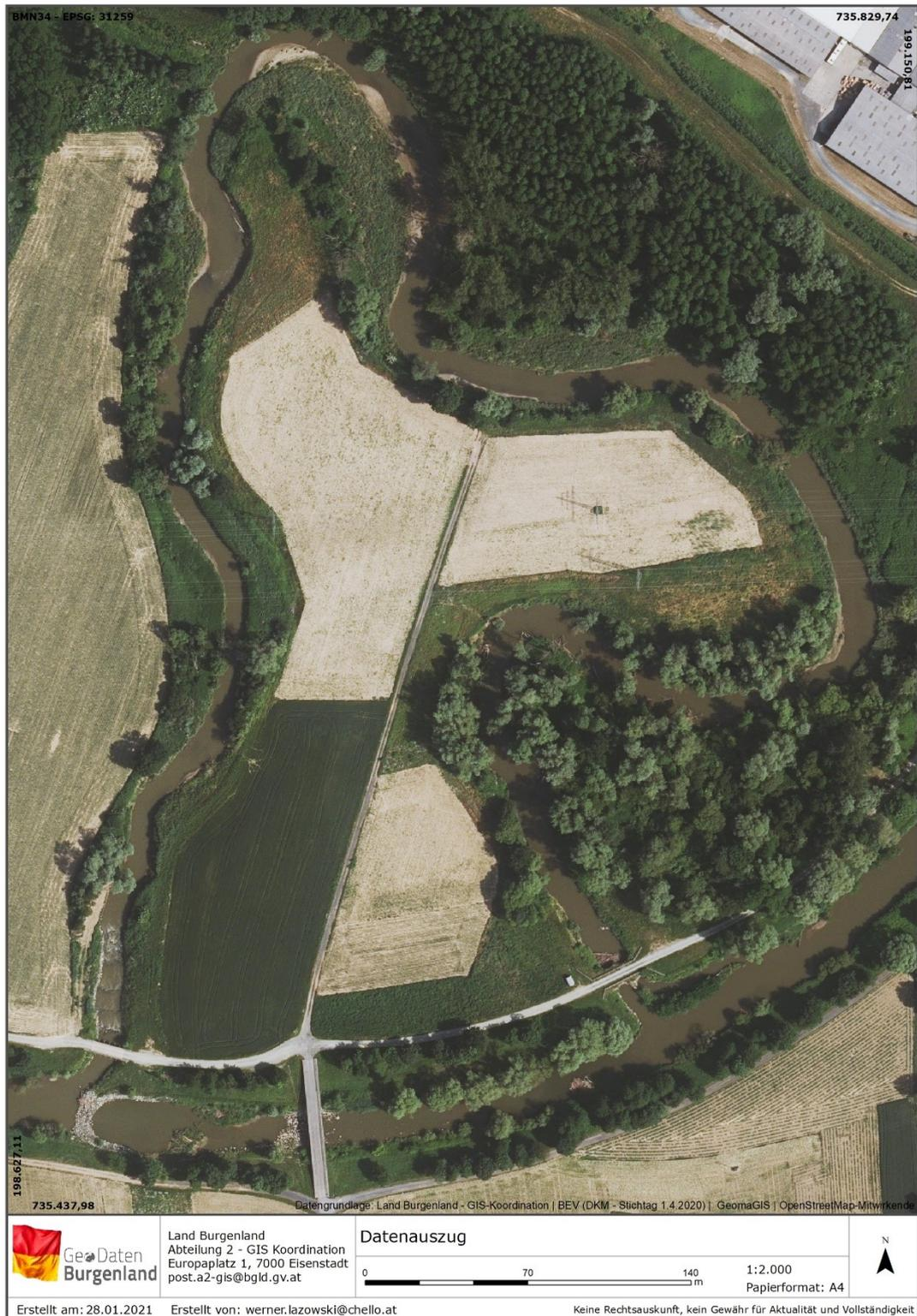
Abbildung 13: Rückgebauter Vossen-Arm bei Jennersdorf. Mittelwasser-Ausleitung aus dem regulierten Raab-Durchstich (im Bild unten) © Land Burgenland
